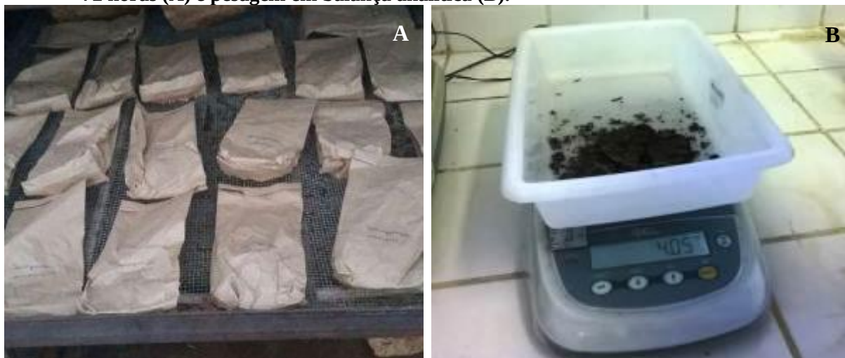
Figura 8-Secagem do material remanescente em estufa de circulação forçada de ar a 65 °C por 72 horas (A) e pesagem em balança analítica (B).
