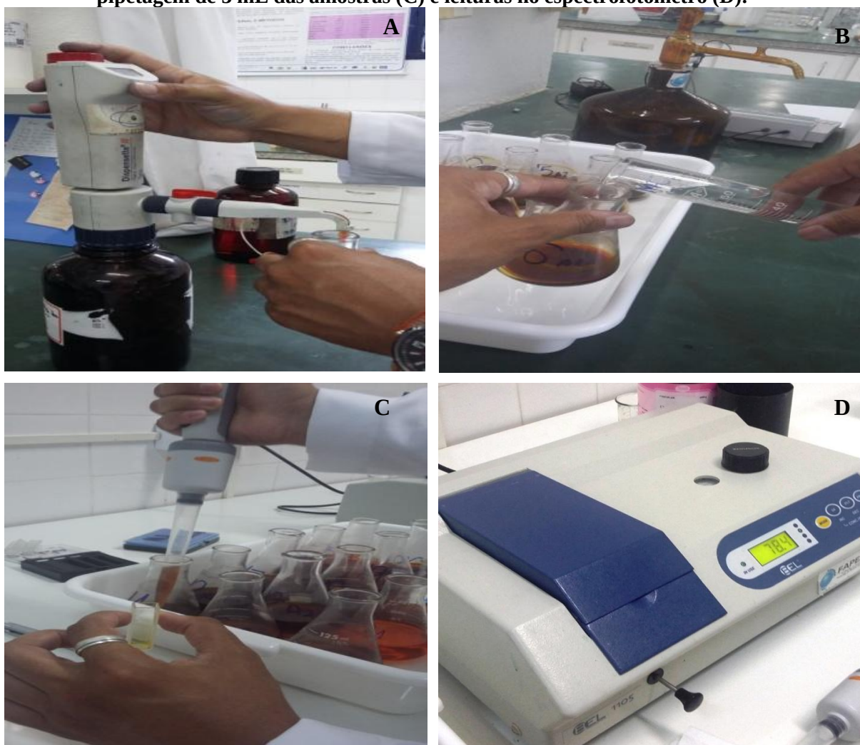
Figura 10-Adsorção de dicromato de sódio nos erlenmayers (A), adsorção de água destilada (B) pipetagem de 3 mL das amostras (C) e leituras no espectrofotômetro (D).
