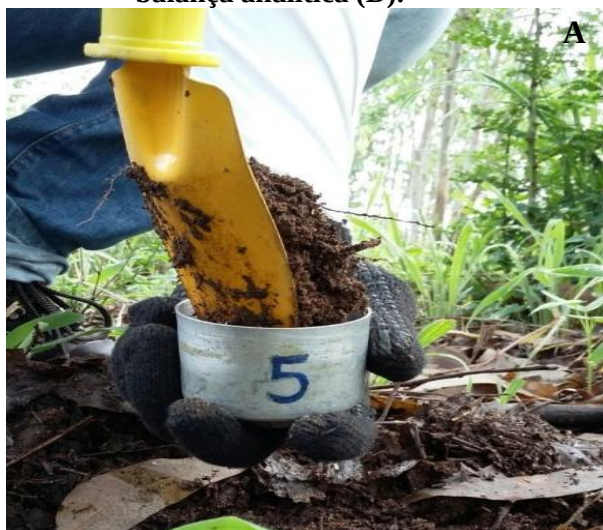
Figura 11-Coletas das amostras de solo (A), pesagem do solo úmido em balança analítica (B), secagem das amostras em estufa a 105 °C por 24 horas (C) e pesagem de solo seco em balança analítica (D).
