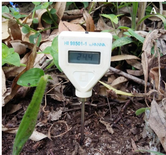
Figura 11-Medição da temperatura do solo na superfície (A) e na subsuperfície (B) nas áreas experimentais, de plantio de Eucalyptus spp. e de Caatinga.
