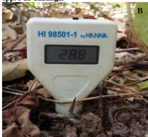
Figura 11-Medição da temperatura do solo na superfície (A) e na subsuperfície (B) nas áreas experimentais, de plantio de Eucalyptus spp. e de Caatinga.
