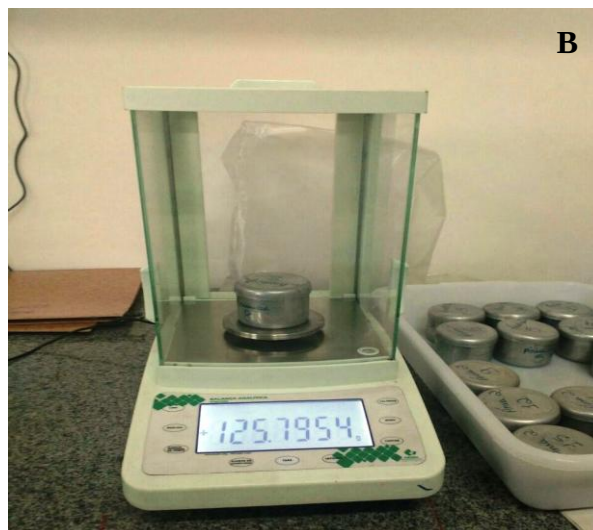
Figura 11-Coletas das amostras de solo (A), pesagem do solo úmido em balança analítica (B), secagem das amostras em estufa a 105 °C por 24 horas (C) e pesagem de solo seco em balança analítica (D).
