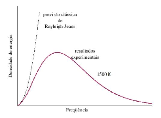
Comparação do espectro de radiação de corpo negro a 1500 K e a curva clássica de Rayleigh-Jeans, destacando-se assim a "catástrofe ultravioleta". Notemos que, enquanto a densidade de energia, segundo a curva experimental, tende a zero, a previsão teórica indica que a mesma tende a infinito.
