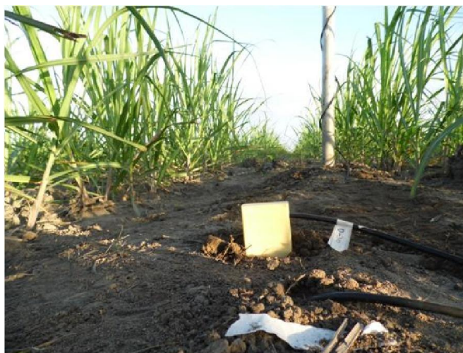
Figura 4 - Sensores de umidade do solo inseridos nas profundidades de 0,0-0,30 m e 0,30-0,60 m.
