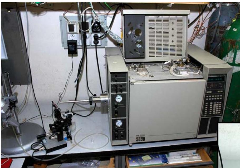
**Figura 17:** Cromatógrafo gasoso (IOCHB)
