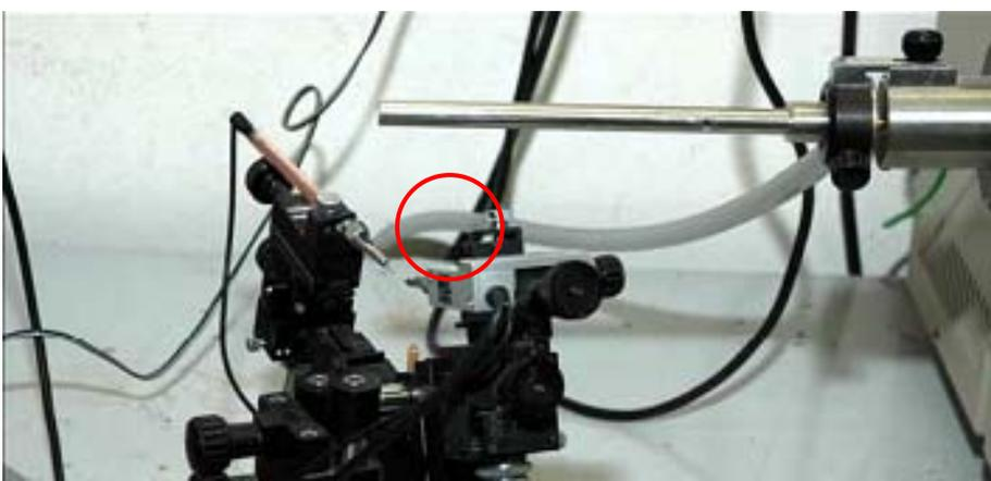
**Figura 18:** Detector Eletroentecnográfico (IOCHB) com ênfase para os eletrodos onde está inserida a antena do macho de *D. flavipennella*.
