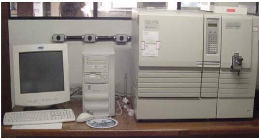
**Figura 19:** Cromatógrafo gasoso acoplado ao espectrômetro de massas utilizado na identificação dos ácidos graxos.
