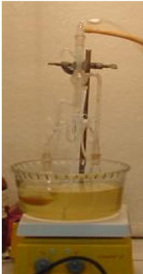
**Figura 2.4.** Aparelho de klavenger utilizado na extração dos voláteis de *M. hirsuta*.
