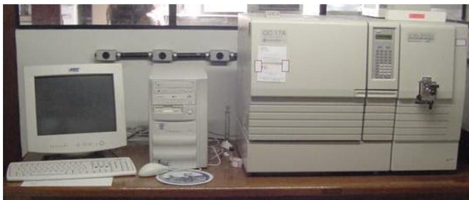
Figura 2.1. Cromatógrafo gasoso acoplado ao espectrômetro de massas utilizado na identificação dos voláteis.
