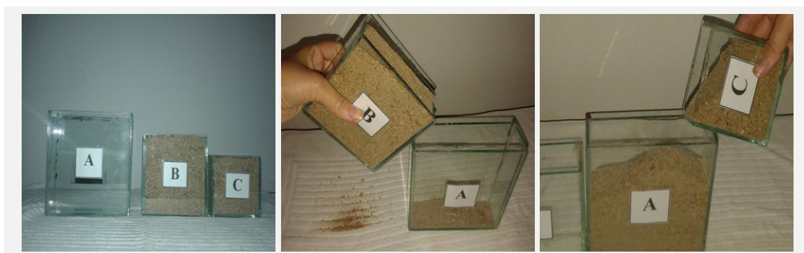
Figura - Enchimento das caixas com areia.
