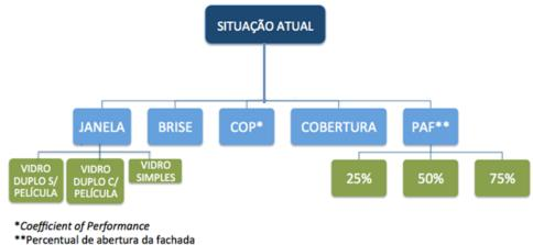
Figura 46: Organograma das simulações termoenergéticas dos ambientes (suítes) expostos à fachada envidraçada do objeto de estudo
