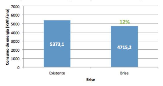
Figura 53: Consumo de energia na situação existente e com a inserção de brise
