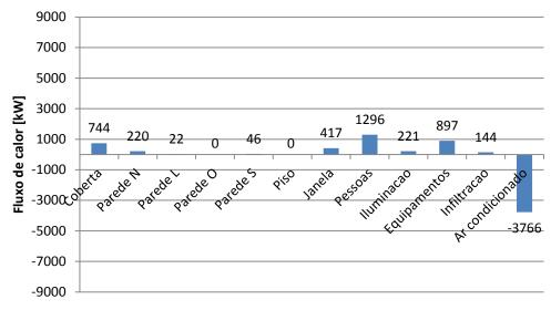
Figura 70: Balanço térmico da proposta
