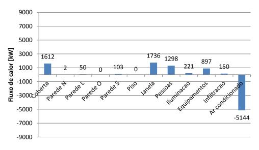
Figura 64: Balanço térmico da suíte com brise
