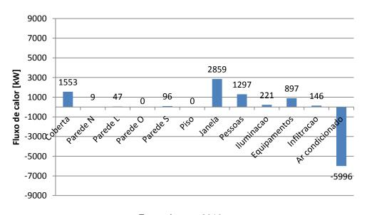
Figura 60: Balanço térmico da situação existente
