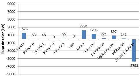
Figura 67: Balanço térmico da suíte alterando para janela com PAF de 75%
