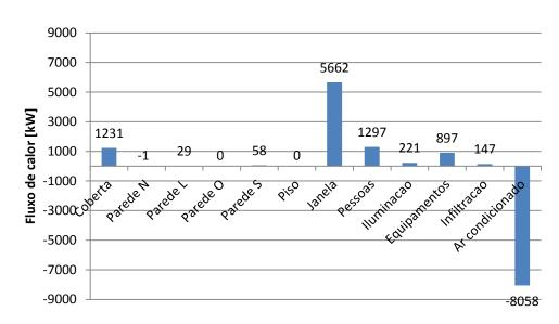
Figura 62: Balanço térmico da suíte alterando a janela para vidro duplo sem película
