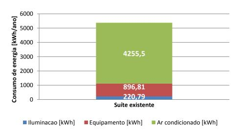
Figura 51: Consumo de energia com iluminação, equipamentos e ar-condicionado
