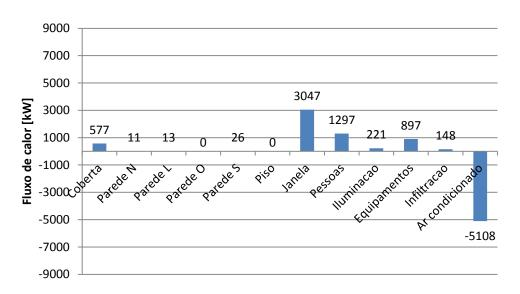
Figura 69: Balanço térmico da suíte alterando a cor da cobertura
