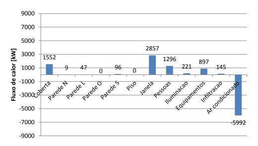
Figura 68: Balanço térmico da suíte alterando o COP
