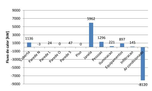
Figura 61: Balanço térmico da suíte alterando a janela para vidro de 10mm sem película
