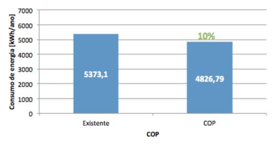
Figura 55: Consumo de energia alterando o COP do ar-condicionado
