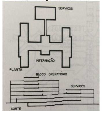
Figura 11: Ottawa Civic Hospital, em forma de "H", com os monta cargas e elevadores situados no meio, evitando grandes deslocamentos
