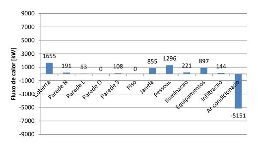
Figura 66: Balanço térmico da suíte alterando para janela com PAF de 50%
