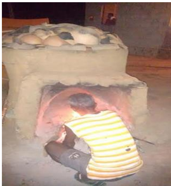
Figura 7. Forno artesanal utilizado na cocção de peças de cerâmica. Muquém, União dos Palmares, Alagoas. Fonte: Arquivo do autor, 2015.
