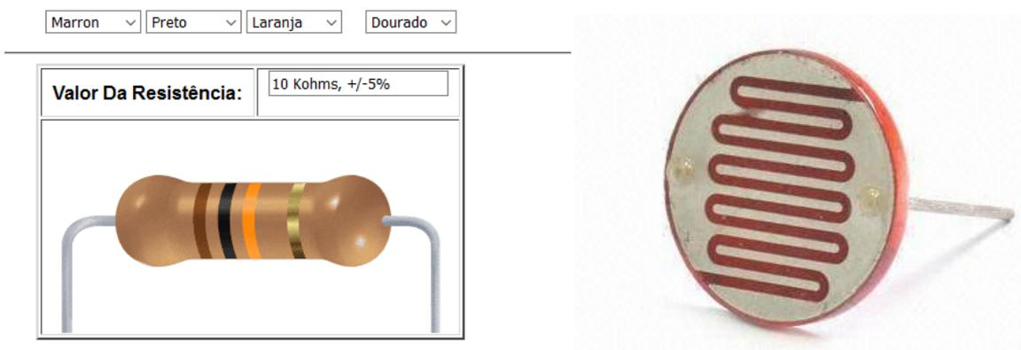
Alimenta-se o sensor com 5V da porta USB do computador para garantir mais estabilidade na alimentação, mas também pode-se usar a porta 5V do Arduino. Para cada sensor usa-se um resistor de  $R = 10\text{ K}\Omega$ .
