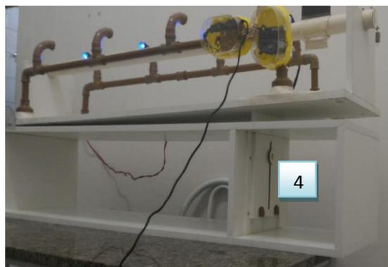
Legenda da figura 11: 1. Distância entre os sensores; 2. Parafuso: Posição ajustável; 3. Posição ajustável chegando até 16 cm; 4. Elevador (Suporte de madeira que suspende a base móvel do aparato experimental, em uma inclinação desejável de  $0^\circ$  até  $12^\circ$  e que chega a uma altura de 16 cm).
