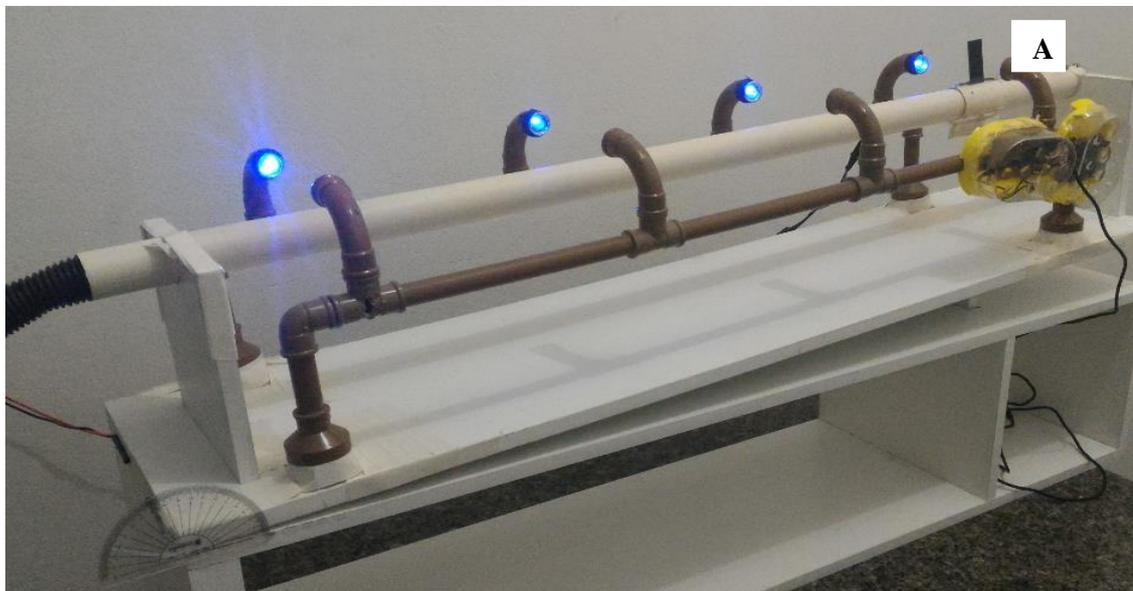
Realizada a medição entre os sensores no experimento passado  $\Delta S = 27,5 \text{ cm}$ , foi calculada a aceleração escalar entre os sensores 0-1, 0-2 e 0-3, com o objetivo de encontrar um valor aproximadamente constante, utilizando a equação:
