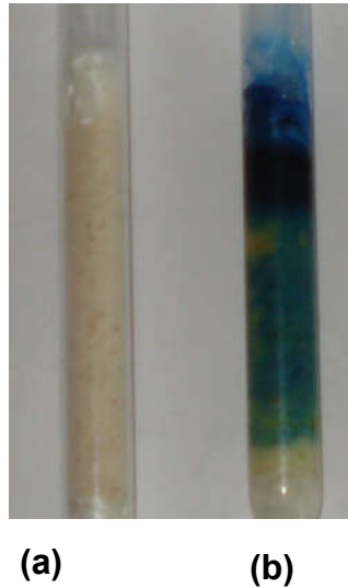
Figura 14 – Foto da coluna de leito fixo (a) quitosana e (b) IC adsorvido em quitosana.
