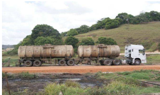
Figura 5 - Transporte da vinhaça por caminhão-tanque.
