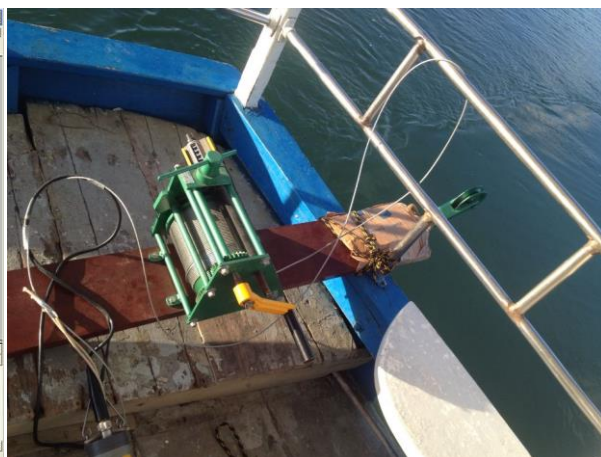
Foto 4: Guincho manual utilizado para descer a sonda multiparamétrica.
