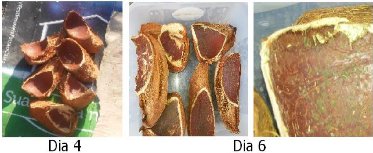
Figura 6 – Aspecto das cascas de coco-verde nos dias 4 e 6 do processo fermentativo
