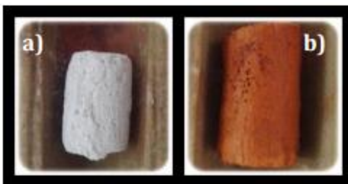
Figura 76. Catalisador \text{Fe}/\text{Al}_2\text{O}_3 : a) suporte catalítico e b) após impregnação de ferro.
