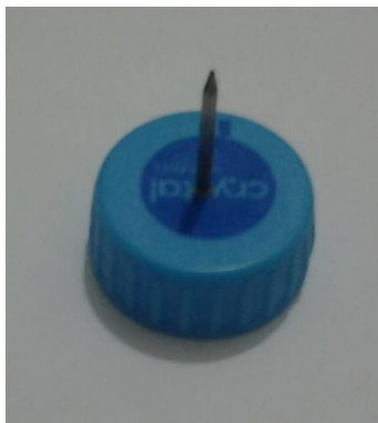
Figura 3: base do versorium feito com um prego fixado em tampinha de garrafa pet.
