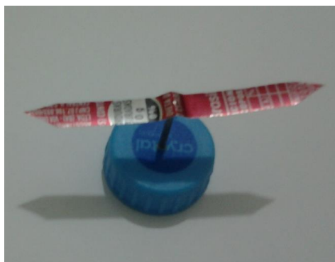
Figura 4: versorium construído com materiais de baixo custo
