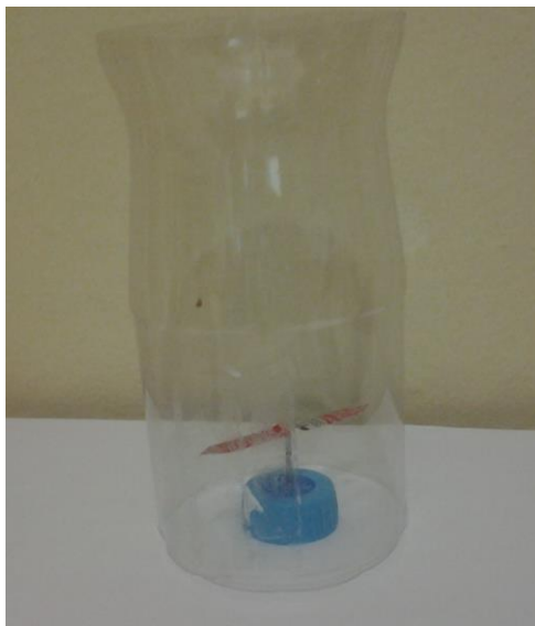
Figura 5: versorium no interior de garrafa pet transparente. Para outras demonstrações, envolver a garrafa com papel toalha e depois com papel alumínio.
