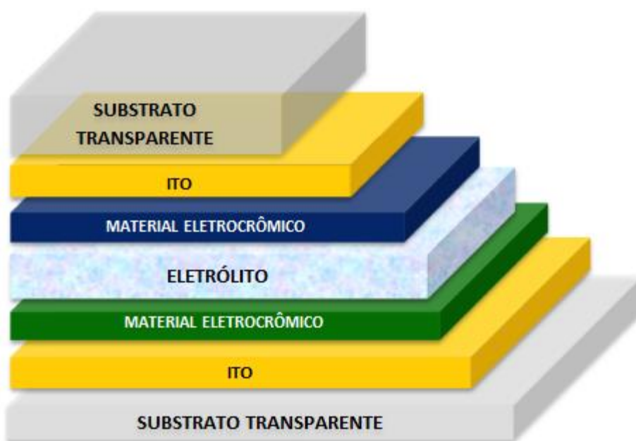
Figura 10 - Esquema representativo de um dispositivo eletrocromico.
