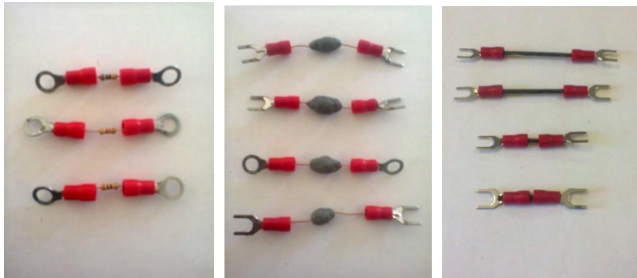
Figura 25 - Resistores utilizados: (da esquerda para a direita) resistor industrial de filme de carbono, resistor feito a partir de resina epóxi e lã de aço, e resistor de grafite retirado de lápis comum.
