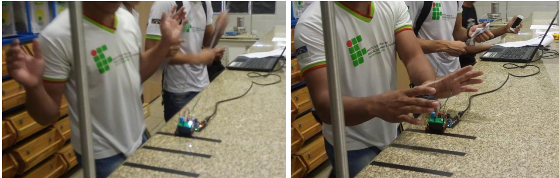
Figura 36 - Aluno aproximando as mãos carregadas da antena do eletroscópio e apagando o LED.
