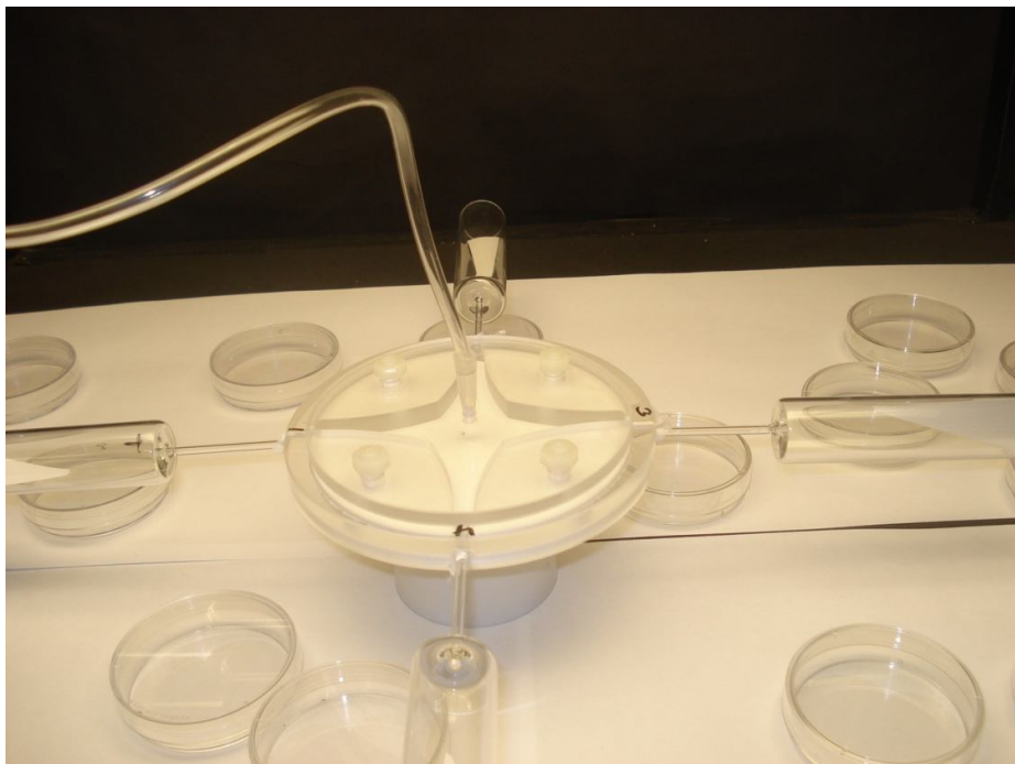
Figura 15– Detalhe do bioensaio com olfatômetro de 4 braços. (Foto: João Gomes da Costa, 2009)
