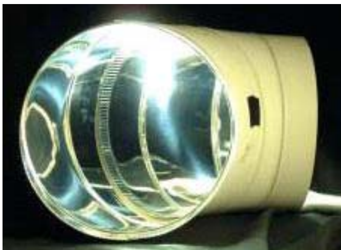
Figura 8 - Duto de luz com cobertura altamente refletiva Fonte: IEA, 2000
