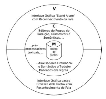
Figura 5.2: Diagrama do Falibras baseado no modelo MVC.
