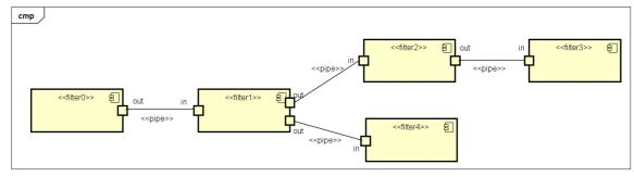
Figura 2.8: Diagrama UML do Estilo Pipe-and-Filter
