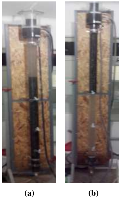
Figura 24 – RALF 2 : (a) Leito fluidificando normalmente e (b) empacotamento do leito.
