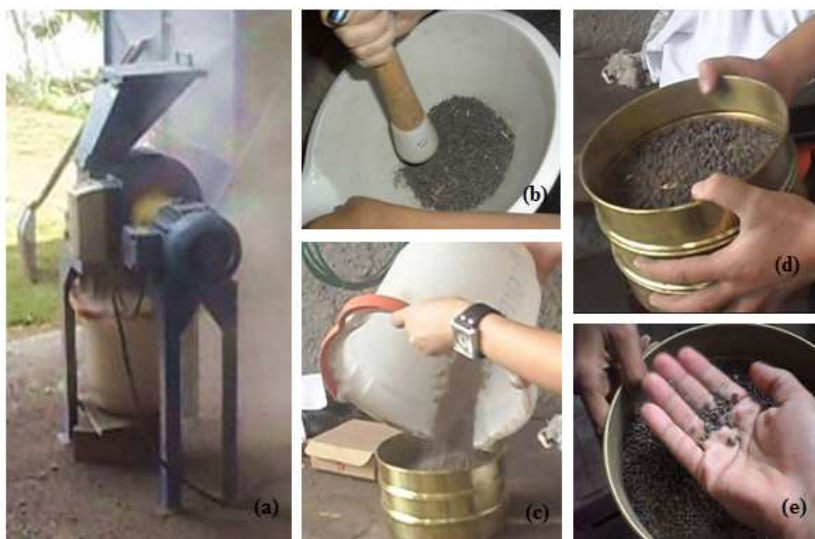
Figura 4 – Processo de redução granulométrica da argila expandida: (a) trituração no moinho; (b) trituração manual; (c) e (d) peneiramento; (e) argila expandida na faixa granulométrica desejada (2,8–3,35mm) após o peneiramento.
