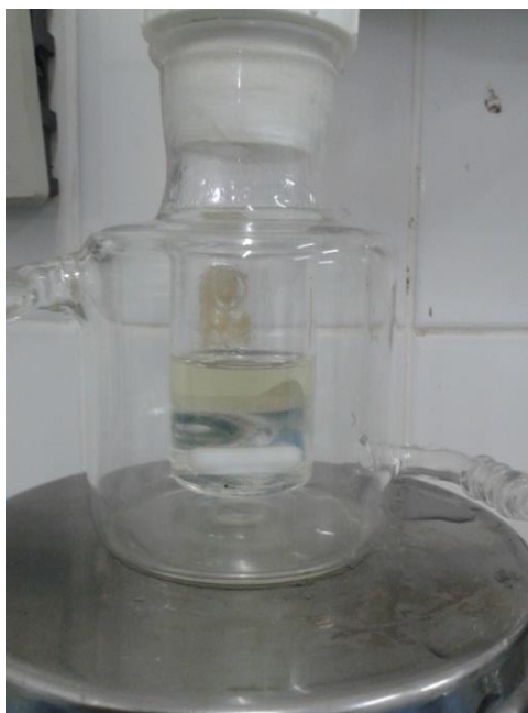
Figura 4.3 - Separação de fases, fase superior rica em biodiesel, fase inferior rica em glicerina.
