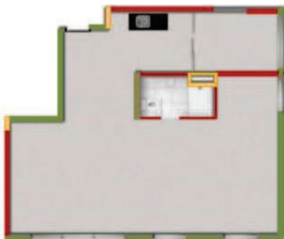
Figura 82: Planta do MaxHaus Itaim. Todas as paredes em vermelho são demolíveis.
