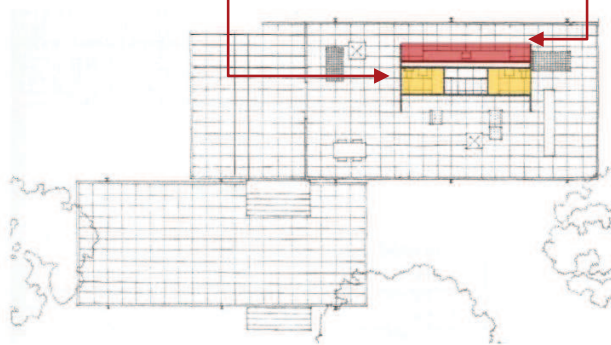
Figura 24: Planta da Casa Farnsworth, 1946-50, Mies van der Rohe. Destaque para a cozinha, em vermelho, e os banheiros, em amarelo [modificada pela autora].
