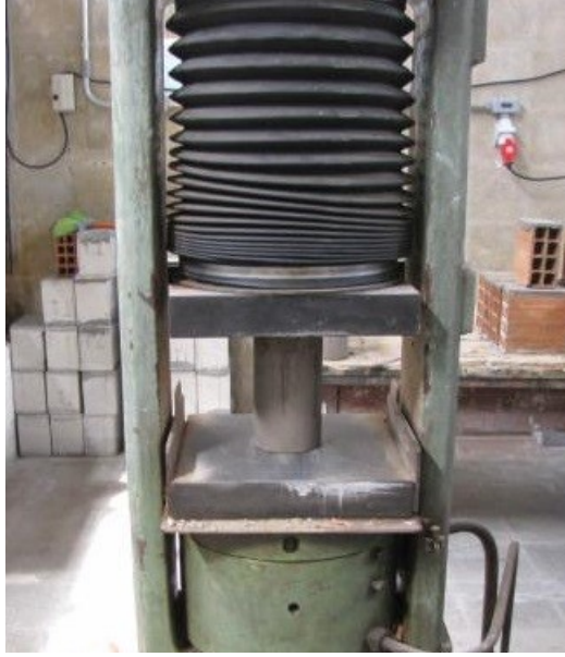
Figura 18 – Ensaio de resistência à compressão
