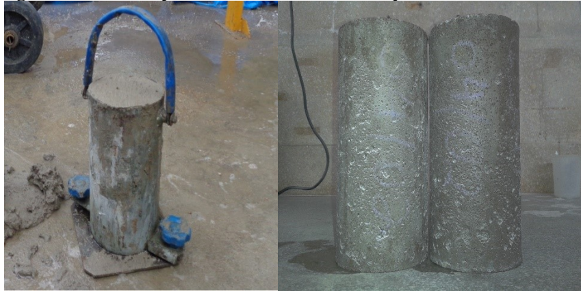
Figura 17 – Molde preenchido e identificado após desmolde
