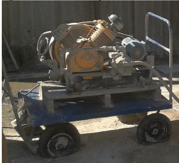
Figura 12 – Gerador de espuma
