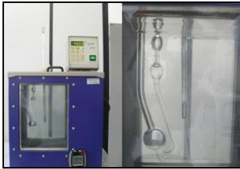
Figura 4.3. Viscosímetro de vidro imerso em um banho termostatizado.
