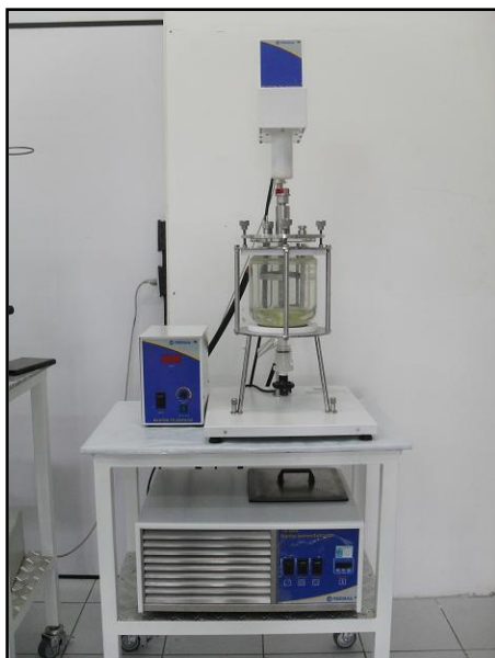
Figura 4.5. Unidade piloto de transesterificação.
