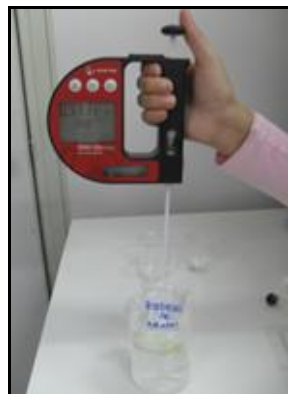
Figura 4.4. Densímetro digital e amostra imersa no banho de gelo.
