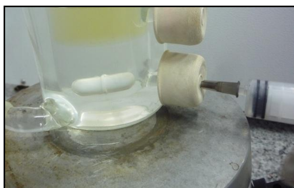
Figura 4.9. Retirada da amostra da fase inferior com auxílio de uma seringa.
