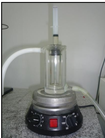
Figura 4.6. Sistema para determinação da curva binodal.
