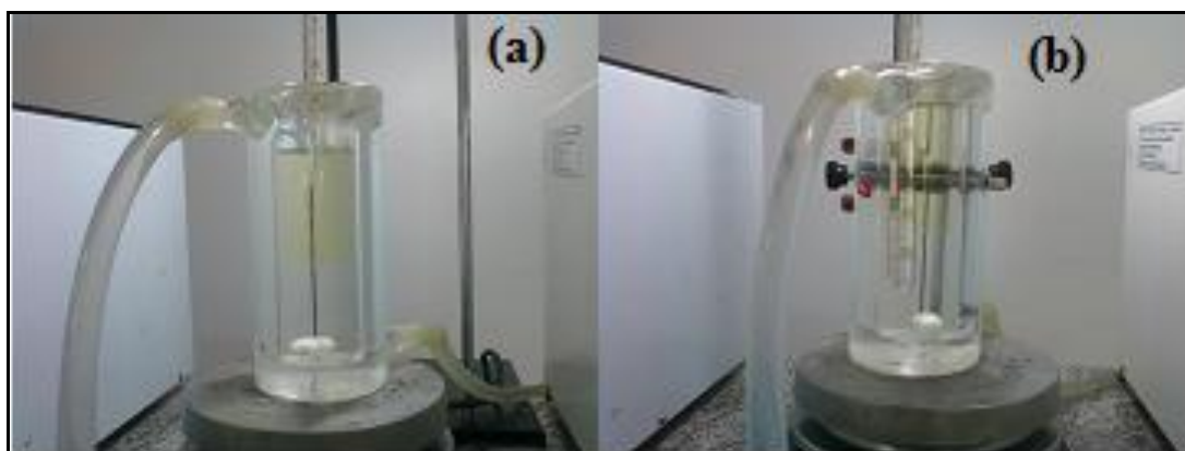
Figura 4.8. (a) Retirada da amostra da fase superior (b) Retirada da amostra da fase inferior.
