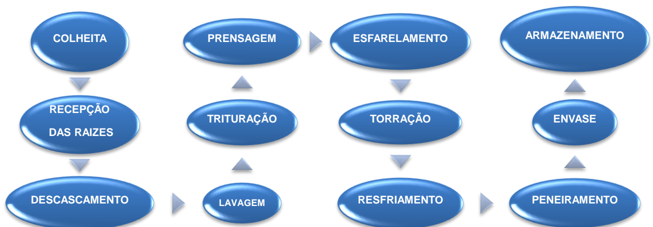
Figura 7: Fluxograma das etapas do processamento da mandioca para a produção de farinha.
