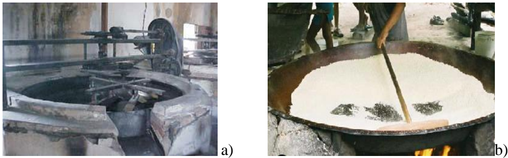
Figura 15: Forno torrador. a) mexedor elétrico e b) artesanal, com rodo de madeira.
