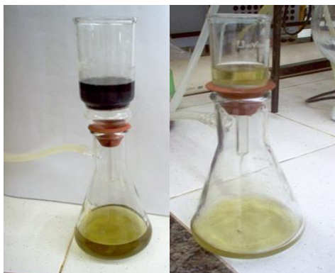
Figura 17-Separação do ácido graxo e o carvão ativado, com o auxílio de um funil sinterizado.
