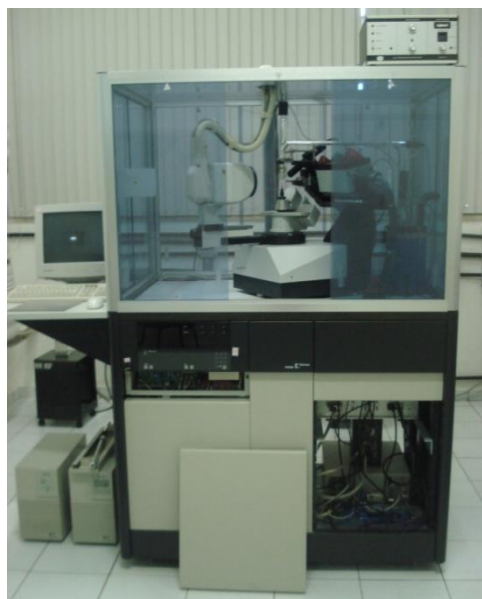
Figura 32. Difratômetro automático Kappa CCD do Laboratório de Cristalografia e Modelagem Molecular do IQB-UFAL.
