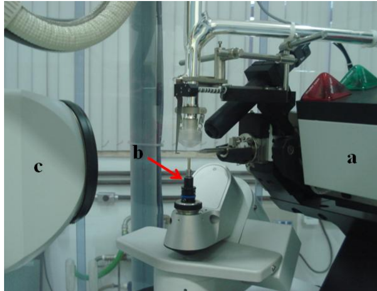
Figura 33. Visão detalhada do difratômetro. (a) Fonte de raios X; (b) cabeça goniométrica e (c) detector de imagens.
