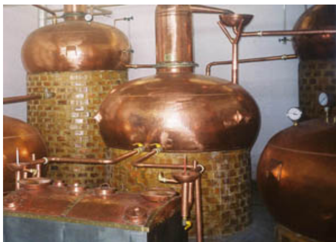
Figura 1. Alambique de Cobre para a fabricação de cachaça.
