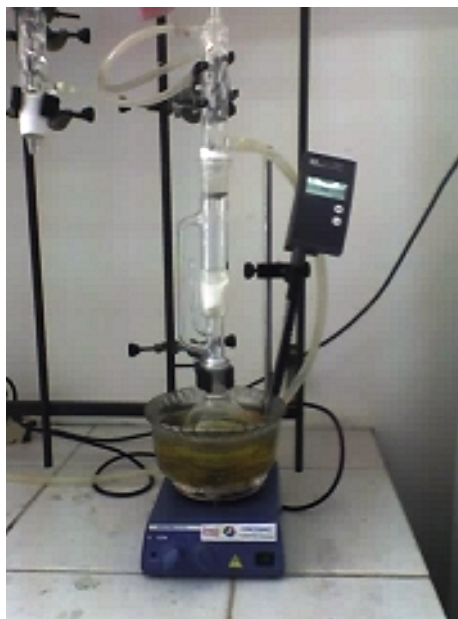
Figura 28. Sistema utilizado para a extração do excesso do 3-aminopropiltriétoxissilano na superfície da sílica.
