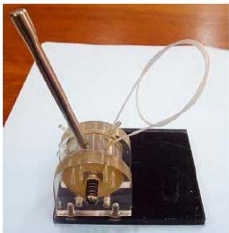
Figura 9. Injetor proporcional de 6 vias com alça de amostragem.
