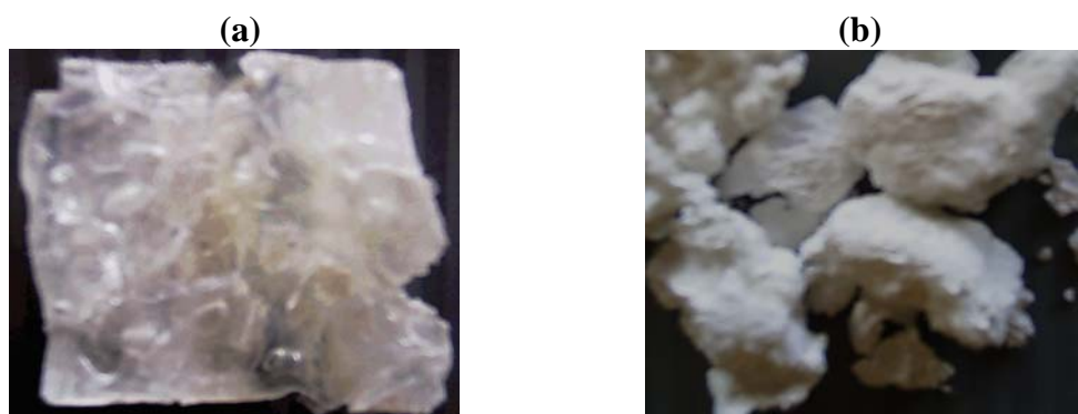
Figura 4.12. Imagens fotográficas dos (a) copolímero de eteno/1-hexeno e (b) homopolímero de eteno.
