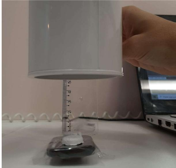
**Figura 4 - Distância foco-filme de 0,5cm, proporcionando uma incidência perpendicular de radiação.**
