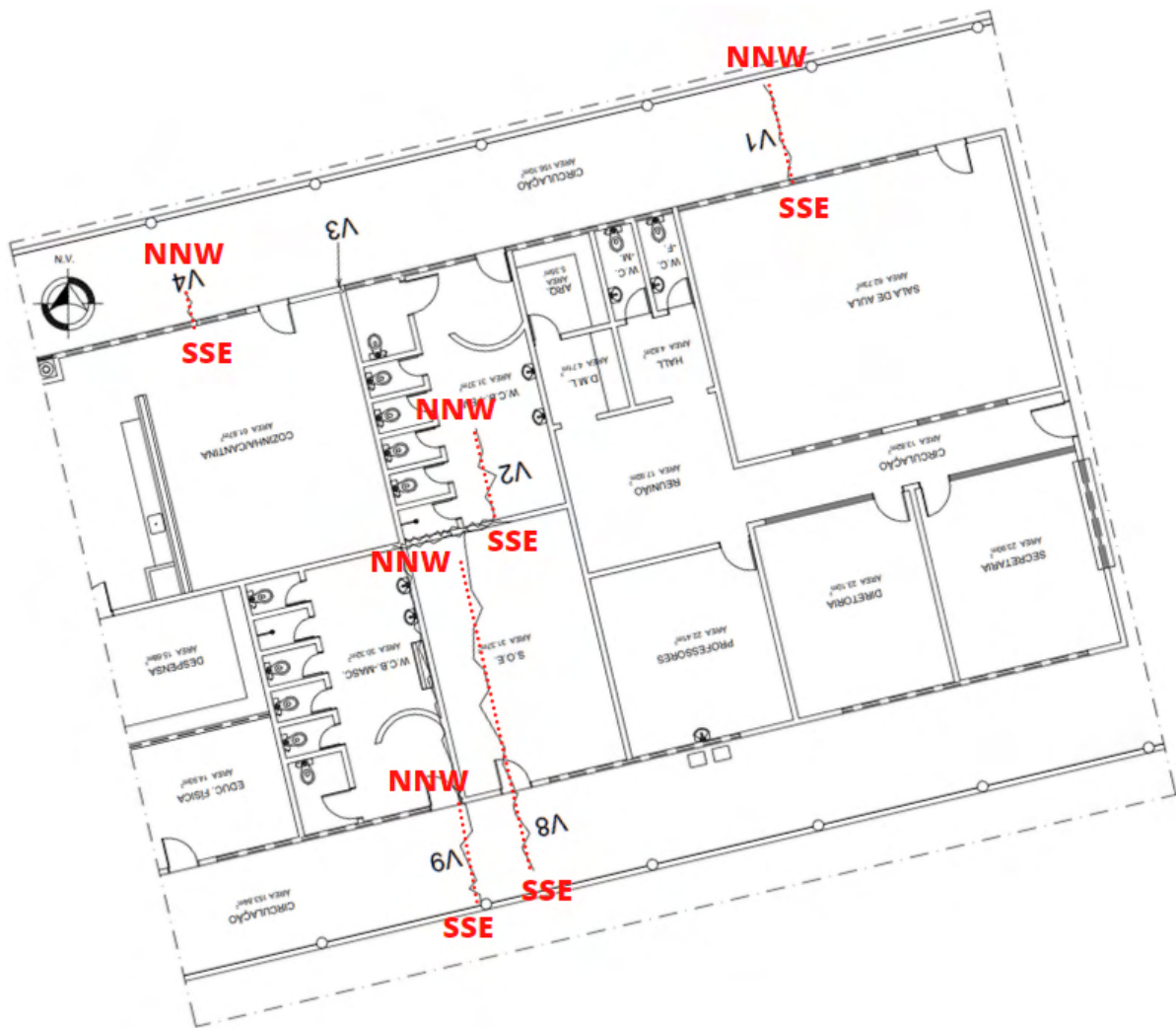
Figura 35 – Orientação aproximada de fissuras nos setores E e F (sem escala)
