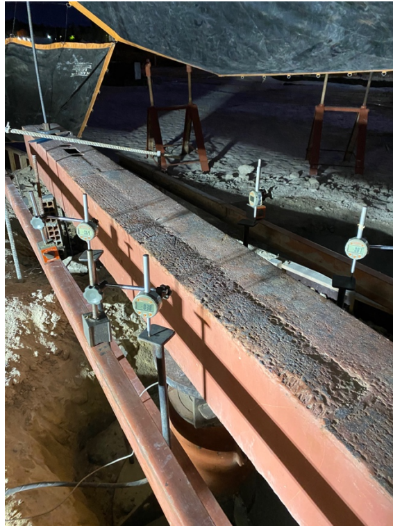
Figura 21: Ensaio de placa PC-03, demonstrando deflectômetros para medição de deslocamentos e utilização de lonas para proteção contra intempéries.
