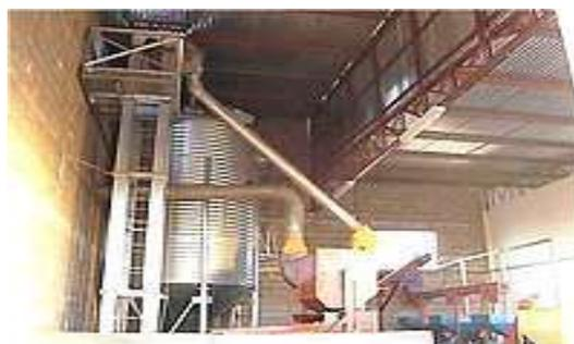
**Figuras 25, 26 e 27** – Mini usina de produção de biodiesel instalada em Mato Grosso com capacidade de produção (4.000 lt/dia).
