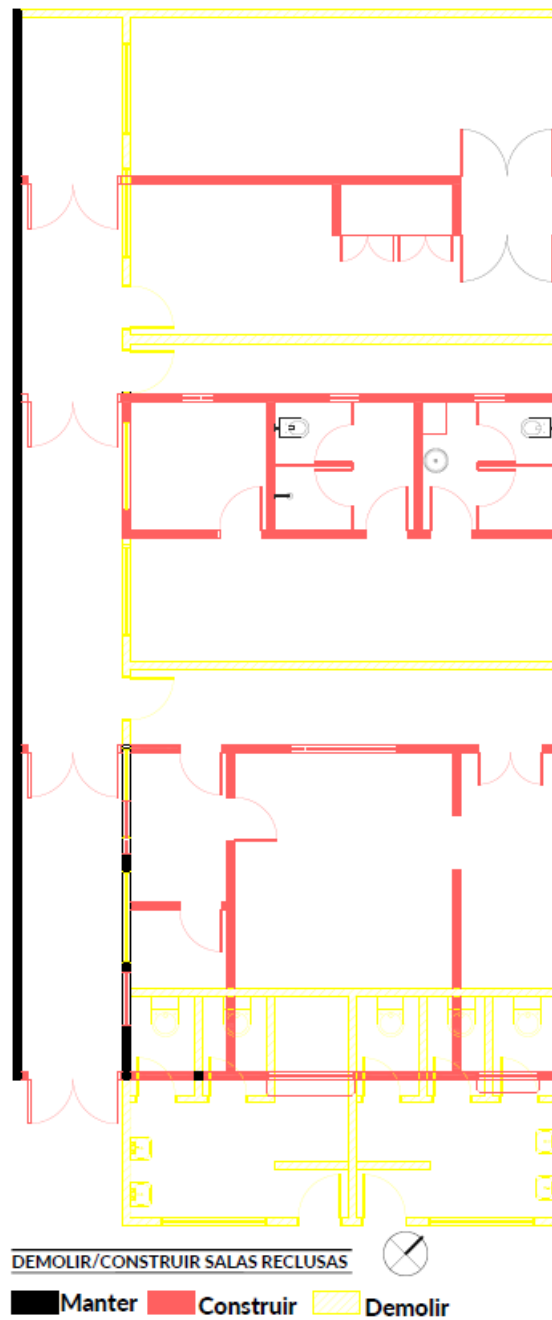
Figura 75 – Proposta de demolir e construir para setor de serviço e cozinha.
