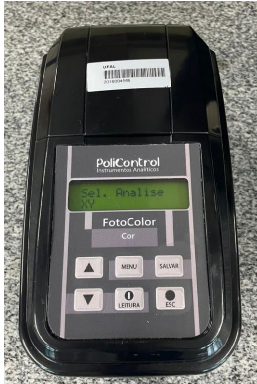
Figura 6- Colorímetro portátil AquaColor Cor da PoliControl
