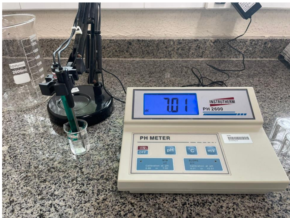
Figura 7- Peagêmetro com escala para leitura de diferença de potencial de pH de 0 a 14
