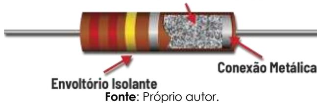
Esse tipo de resistor apresenta uma estrutura de conexões metálicas em aço niquelado revestidos com estanho puro e entre elas é aplicado um bastão de filme carbono sobre o qual existe uma cobertura isolante de cerâmica.
