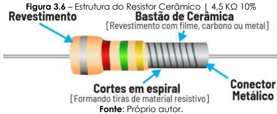
O fio é enrolado em uma base dielétrica e soldado aos nós de contato ou terminais de ligação. Por cima do fio, é aplicado um revestimento isolante. O revestimento isolante é então, coberto com anéis de cores que variam formando assim, o valor codificado.
