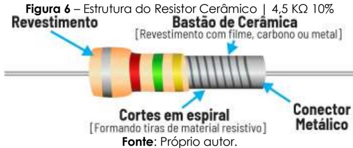
O fio é enrolado em uma base dielétrica e soldado aos nós de contato ou terminais de ligação. Por cima do fio, é aplicado um revestimento isolante. O revestimento isolante é então, coberto com anéis de cores que variam formando assim, o valor codificado.
