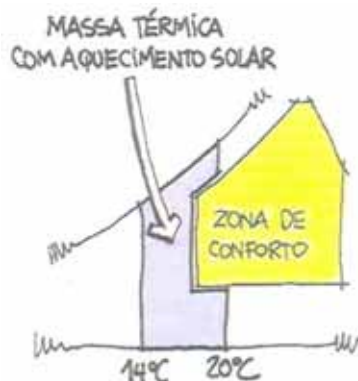
Figura 11: Zona de Massa Térmica para Aquecimento Fonte: Lamberts et al (1997)
