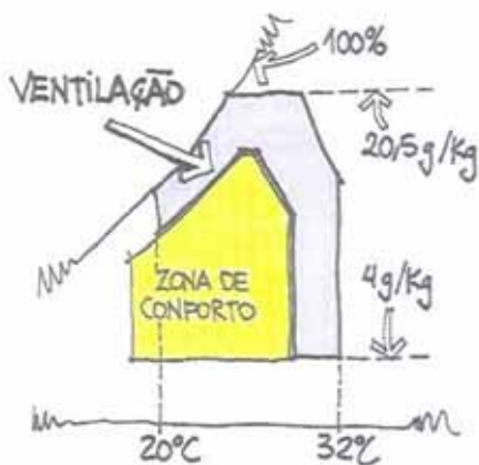
Figura 05: Zona de Ventilação Fonte: Lamberts et al (1997)
