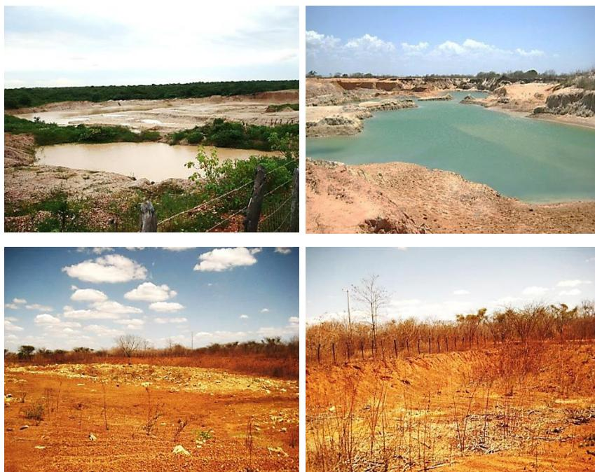
**Figura 1** - Vistas de jazidas de piçarra após o ciclo da extração minerária. Notar as bacias de inundação formadas nas cavas de mineração mais profundas e a falta de ordenamento da paisagem. Nas duas figuras abaixo são mostradas áreas planas. A vegetação nativa de Caatinga pode ser vista ao fundo de cada imagem. Fotos: Guilherme M. Chaer.
