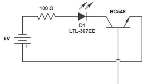
1 - Tendo montado o circuito corretamente, conecte-o à fonte de tensão (tomando cuidado para selecionar a tensão correta, como indicado no diagrama) e observe o que acontece. Após a observação, toque com a ponta do seu dedo o fio ligado ao terminal base do transistor. O que ocorreu? Explique.
