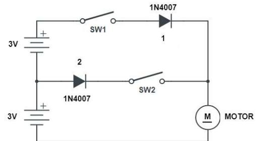
1 - Tendo montado o circuito, acione a chave SW2 e logo em seguida a chave SW1. O que você percebeu? Meça a tensão nos diodos e explique os resultados.
