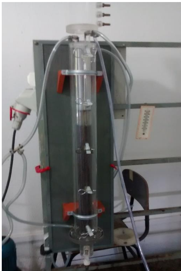
Figura 6 - RALF preenchido com argila expandida.
