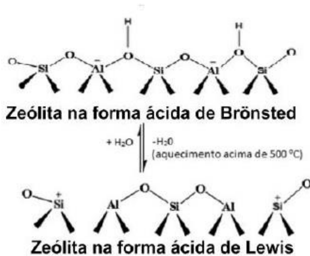
Figura 4 - Reações envolvidas na formação de sítios ácidos de Brønsted e de Lewis em zeólitas.
