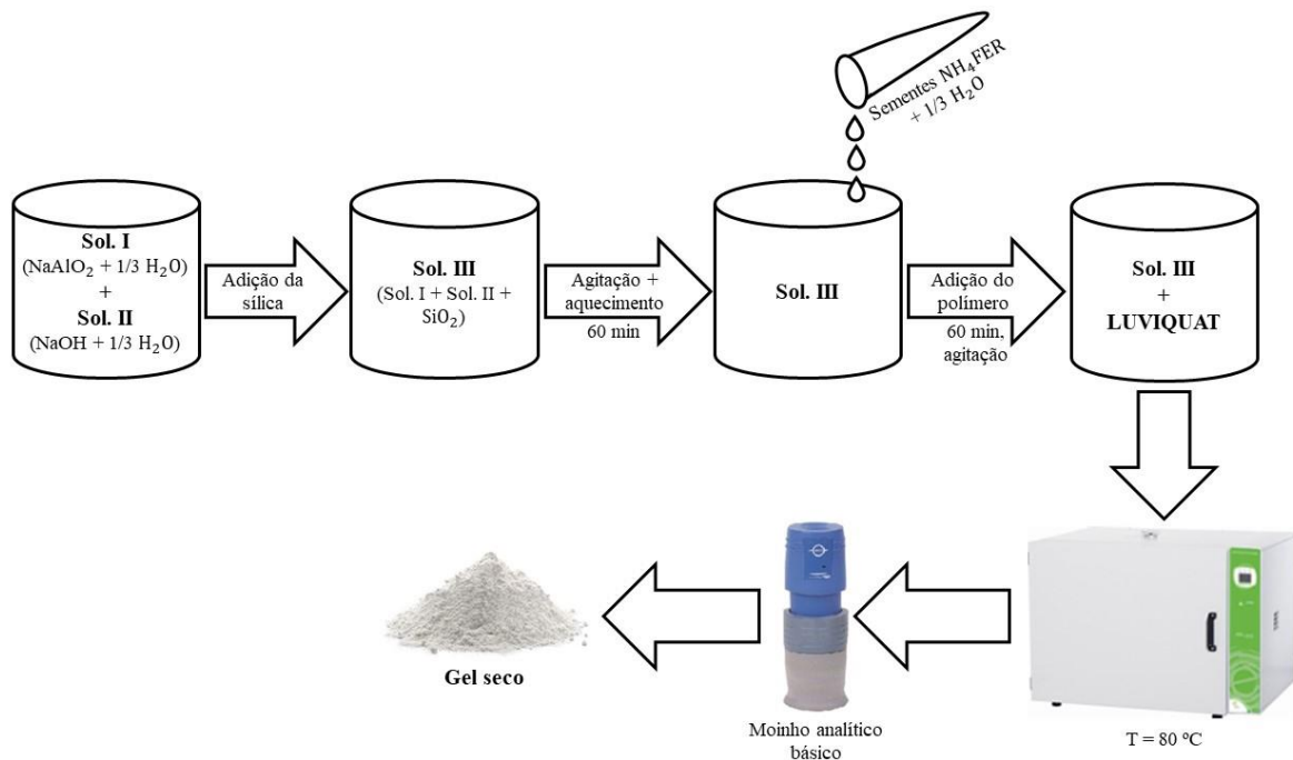
Figura 15 – Esquema do procedimento de preparo do gel seco para síntese da zeólita ferrierita.
