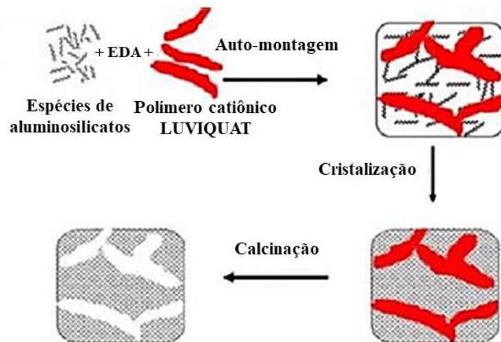
Figura 12 – Ilustração esquemática da zeólita ferrierita mesoporosa usando o polímero catiônico LUVIQUAT.
