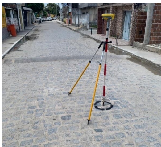
Figura 11 – Alvos marcados em solo com estêncéis e tinta spray na cor preta.
