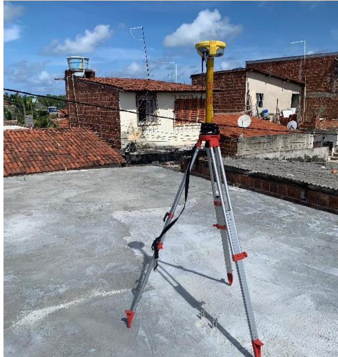
Figura 16 – Receptor base instalado sobre a laje de uma residência.
