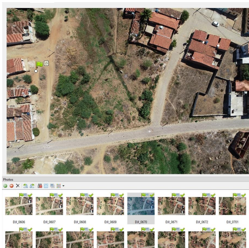
Figura 21 – Processo de marcação do centro dos alvos referentes aos pontos de checagem nas ortofotos.
