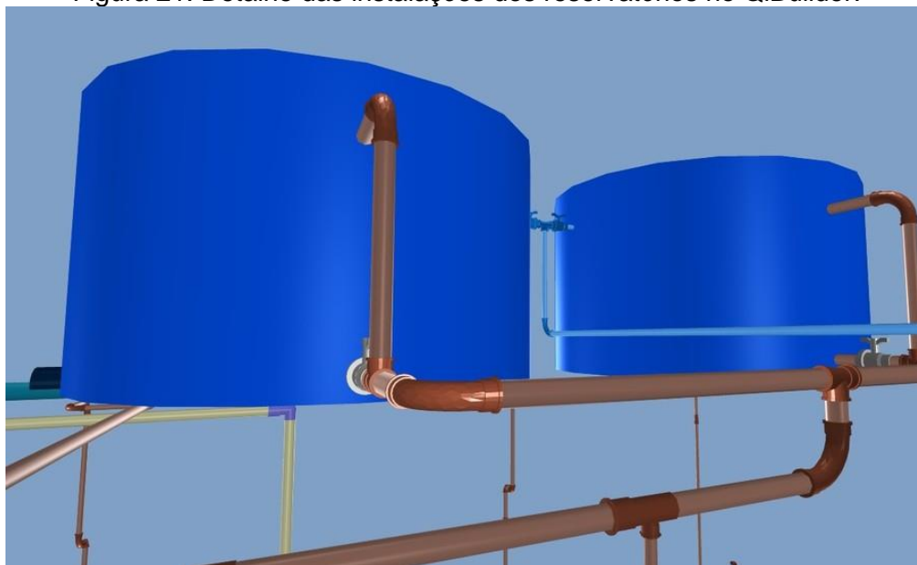
Figura 21: Detalhe das instalações dos reservatórios no QiBuilder.
