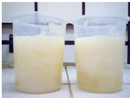
Figura 12: Sabão obtido da saponificação do óleo
