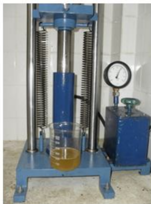
Figura 8: Prensa mecânica usada para extração do óleo da semente de pinhão-manso.
