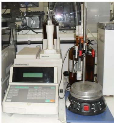
Figura 10: Titulador automático usado para determinar o teor do índice de acidez.
