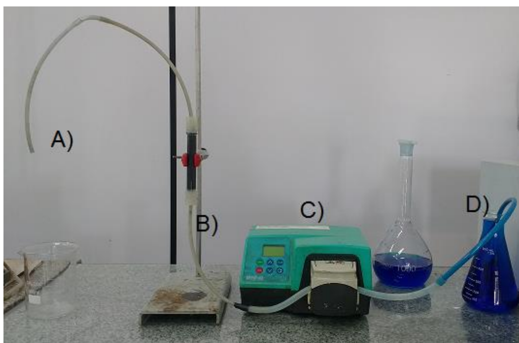
Figura 18 – Coluna de Leito Fixo: A) Saída da coluna; B) Entrada da coluna; C) Bomba peristáltica e D) adsorbato
