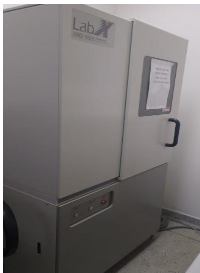
Figura 17 – Difratômetro de raio X (Shimadzu, modelo XDR-6000)
