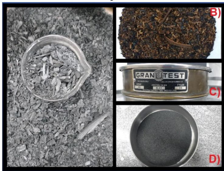
Figura 14 – Biomassa e biocarvão de Stryphnodendron adstringens (Mart) Coville: (A): Biocarvão com granulometria > 0,42mm; (B): Biomassa fragmentada; (C): Peneira Granutest 35 Mesh e (D): Biocarvão com granulometria < 0,42mm.
