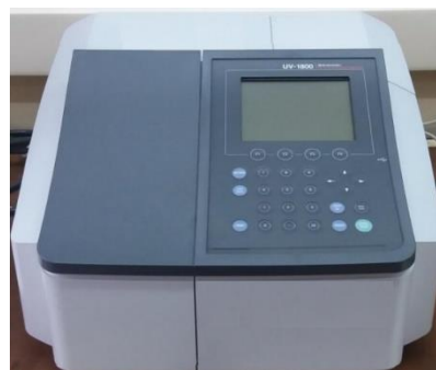
Figura 7. Modelo de reator para o tratamento foto-Fenton e espectrofotômetro utilizados nas leituras de absorvância dos três monoazocorantes
