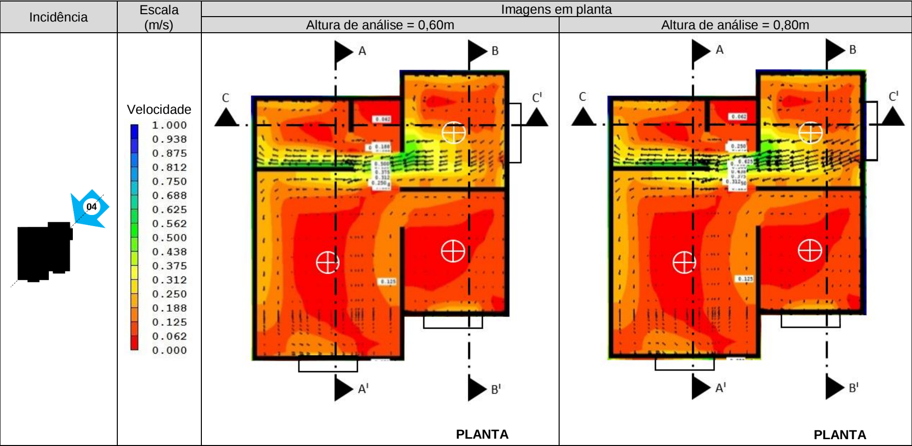
Quadro 155 - JFPH, incidência do vento 4, velocidade 4m/s, escala de cores de 0,00 a 1,00m/s e alturas de análise de 0,60m e 0,80m.
