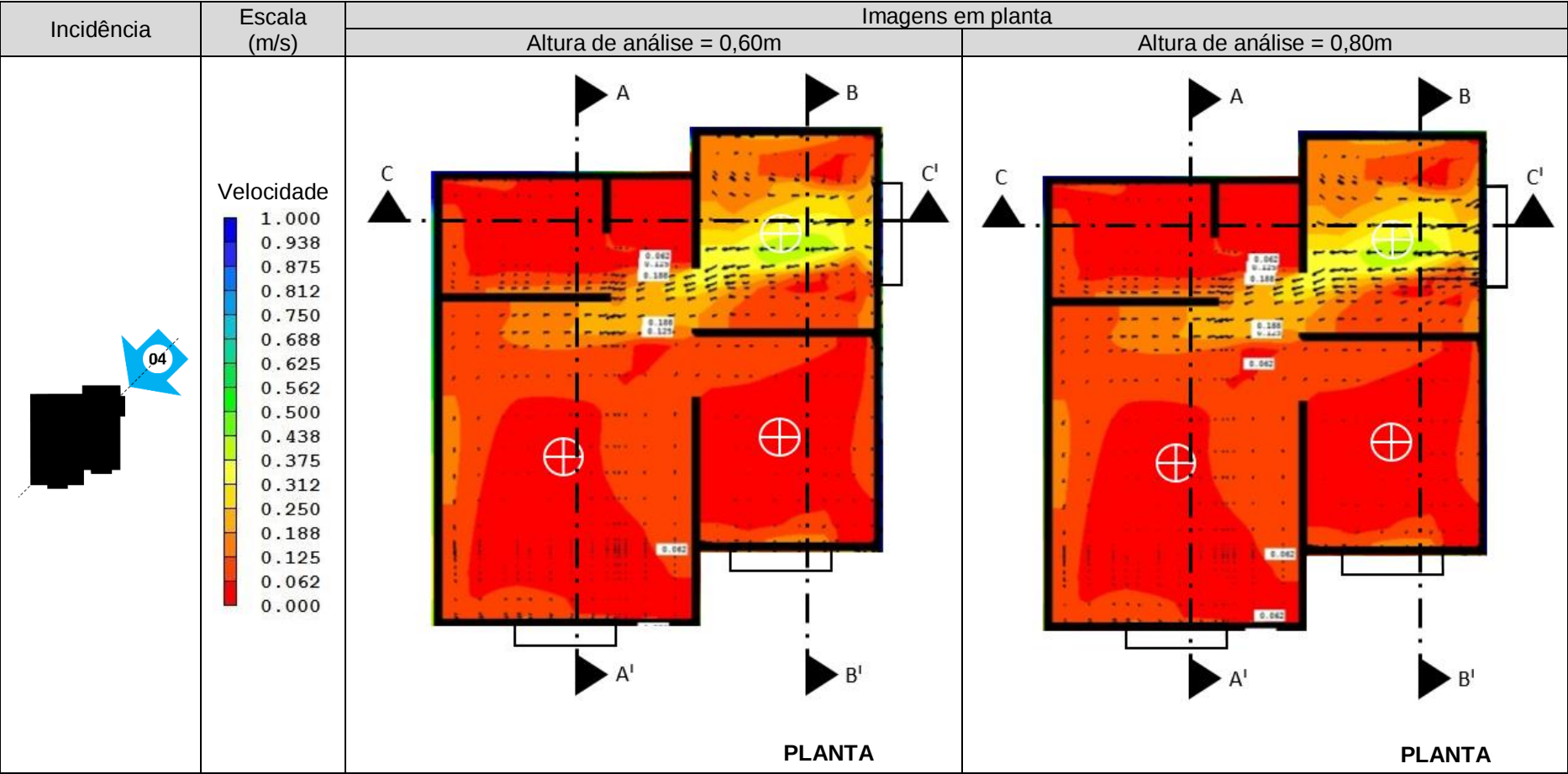
Quadro 179 - JFPC, incidência do vento 4, velocidade 4m/s, escala de cores de 0,00 a 1,00m/s e alturas de análise de 0,60m e 0,80m.
