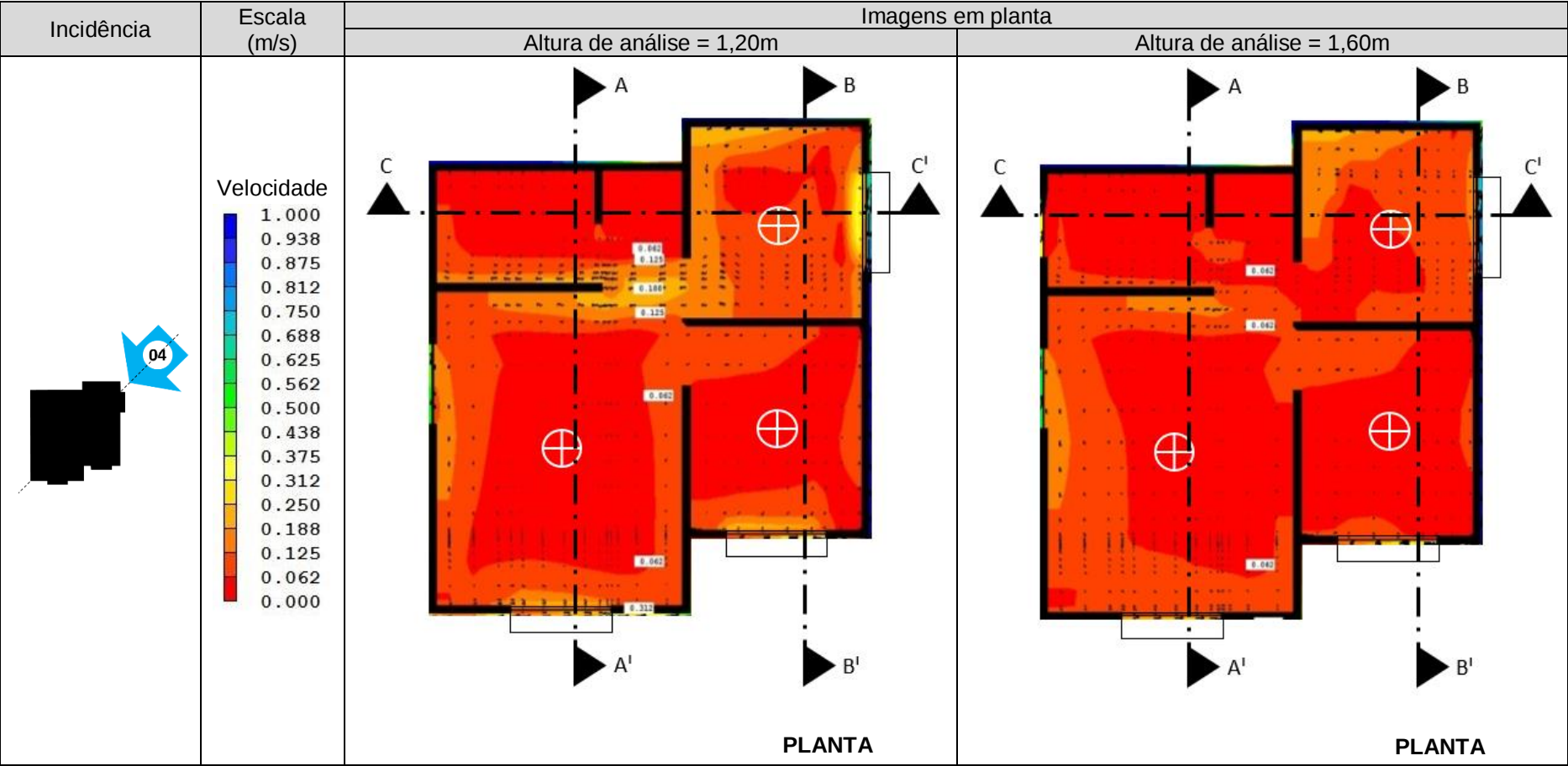
Quadro 180 - JFPC, incidência do vento 4, velocidade 4m/s, escala de cores de 0,00 a 1,00m/s e alturas de análise de 1,20m e 1,60m.
