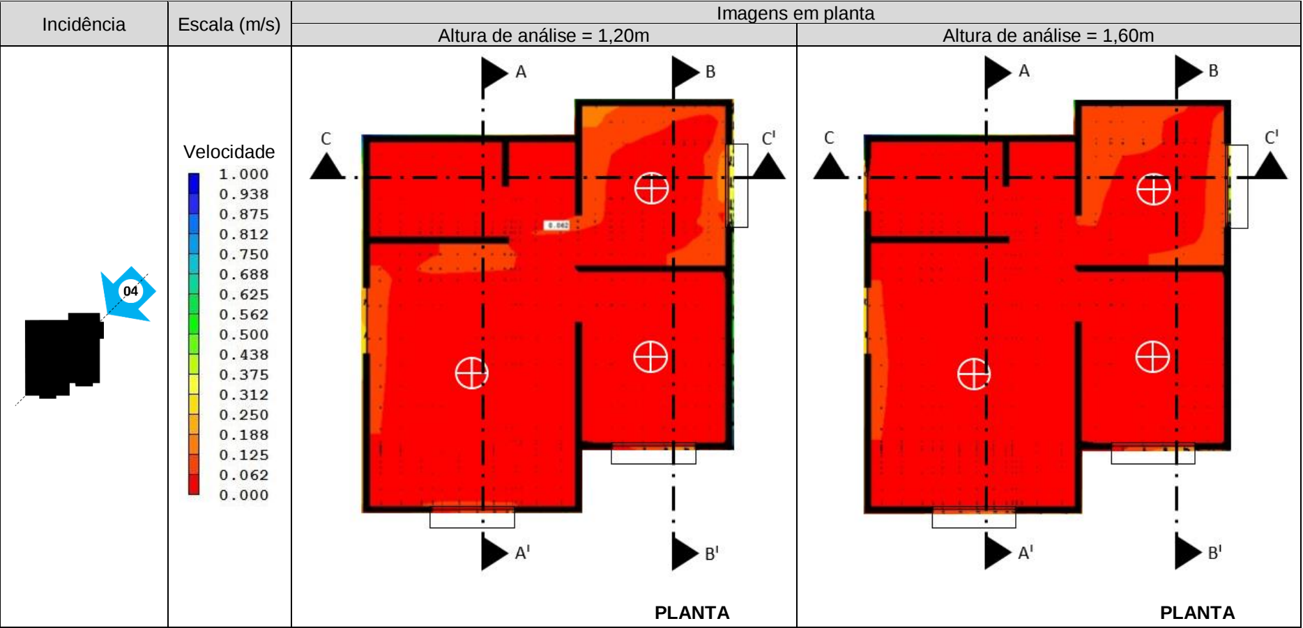
Quadro 192 - JFPB, incidência do vento 4, velocidade 2m/s, escala de cores de 0,00 a 1,00m/s e alturas de análise de 1,20m e 1,60m.
