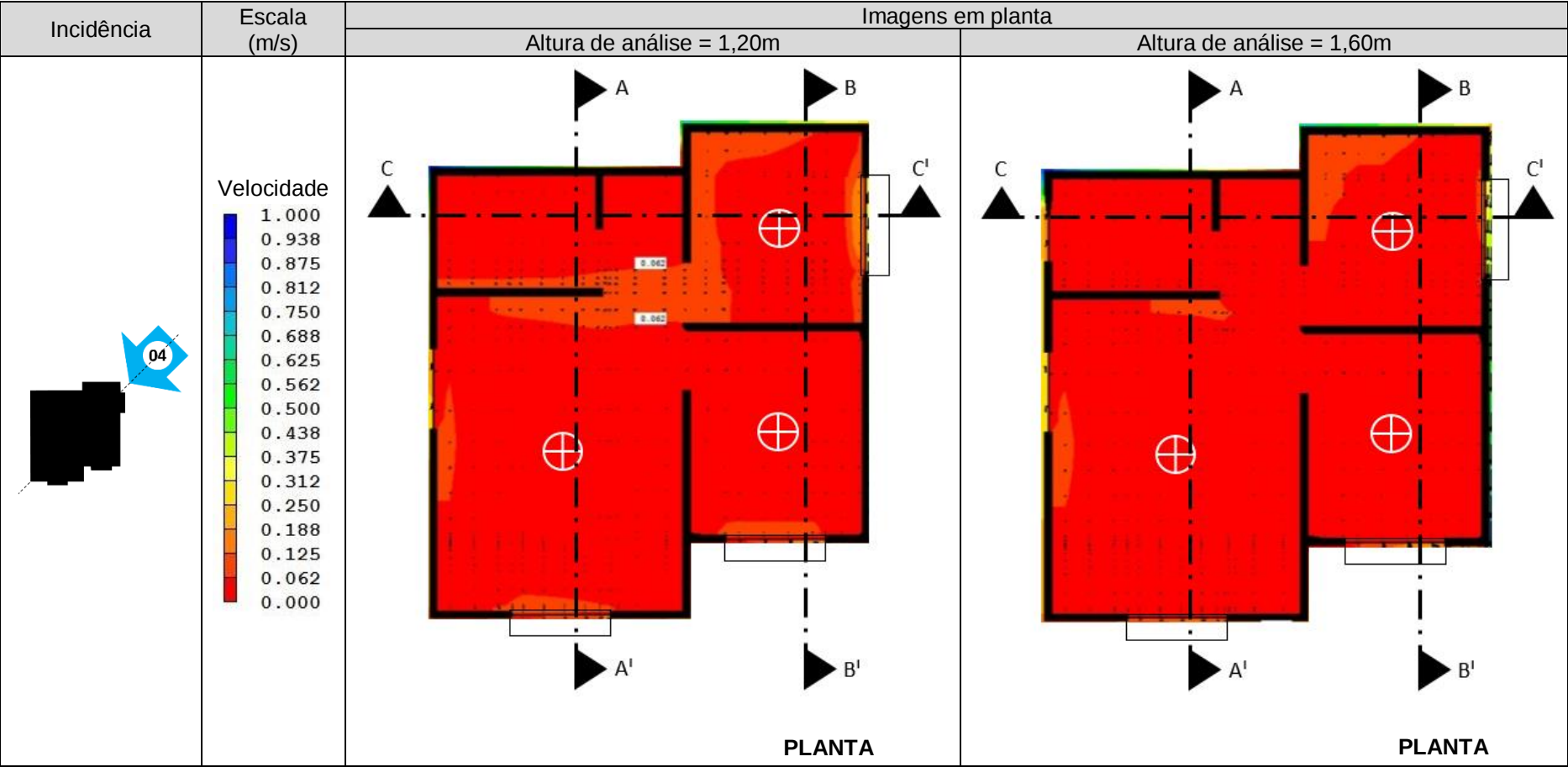
Quadro 168 - JFPC, incidência do vento 4, velocidade 2m/s, escala de cores de 0,00 a 1,00m/s e alturas de análise de 1,20m e 1,60m.
