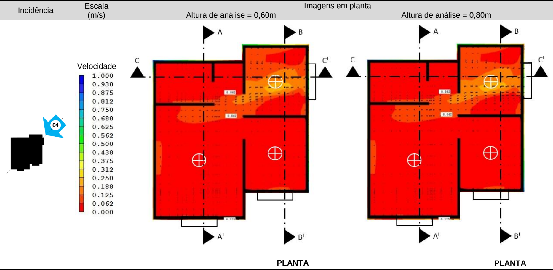
Quadro 167 - JFPC, incidência do vento 4, velocidade 2m/s, escala de cores de 0,00 a 1,00m/s e alturas de análise de 0,60m e 0,80m.
