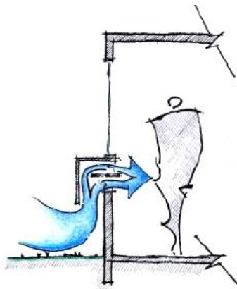
Figura 1 - Peitoril ventilado, corte esquemático.
