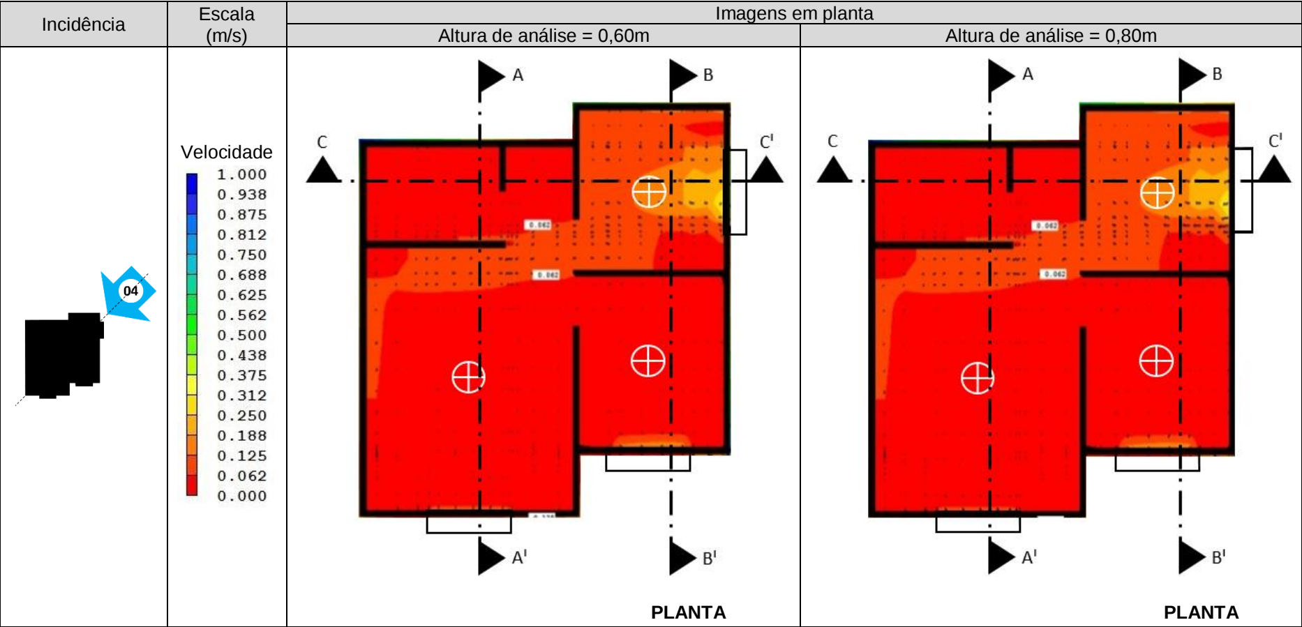
Quadro 191 - JFPB, incidência do vento 4, velocidade 2m/s, escala de cores de 0,00 a 1,00m/s e alturas de análise de 0,60m e 0,80m.
