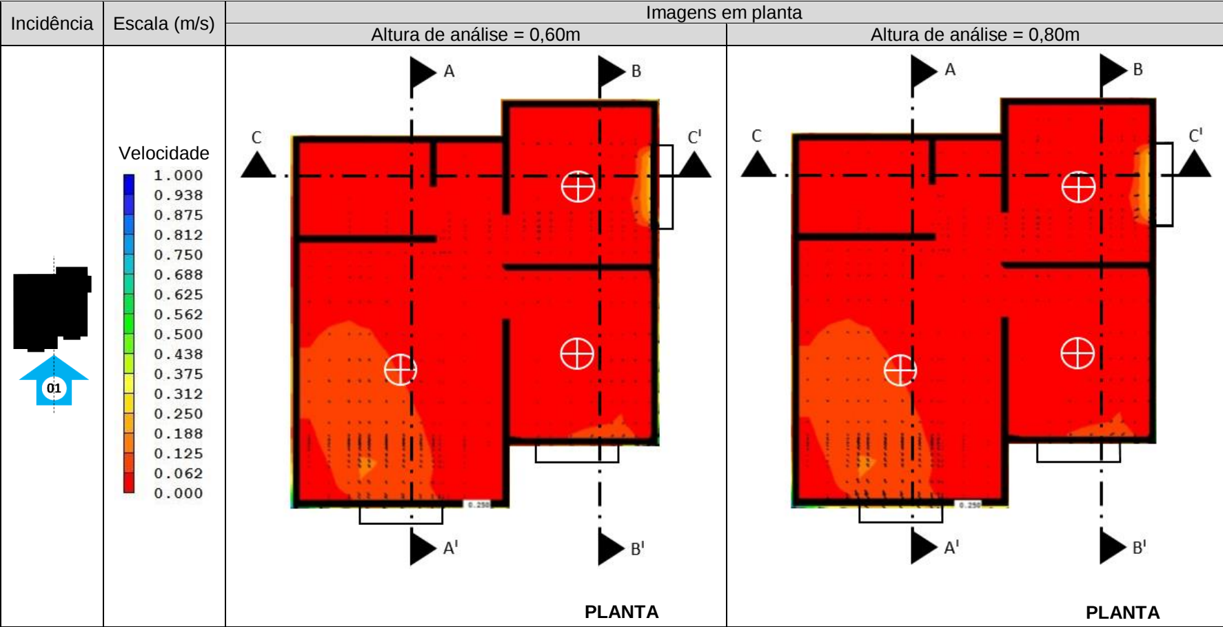
Quadro 182 - JFPB, incidência do vento 1, velocidade 2m/s, escala de cores de 0,00 a 1,00m/s e alturas de análise de 0,60m e 0,80m.
