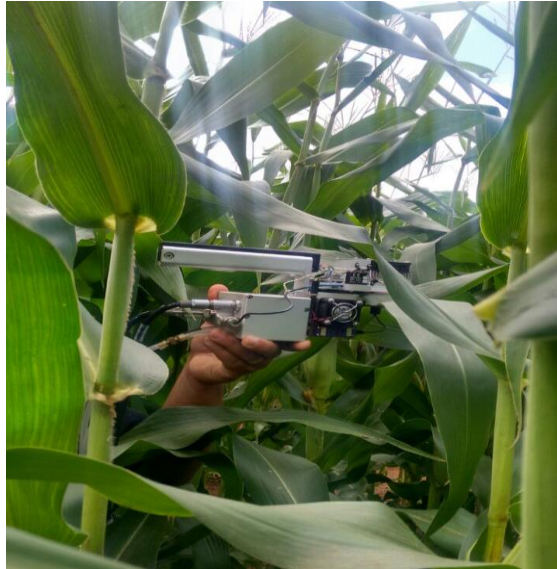
Figura 10 - Análise da taxa fotossintética das folhas de cultivares de milho verde utilizando o analisador de gás a infravermelho.
